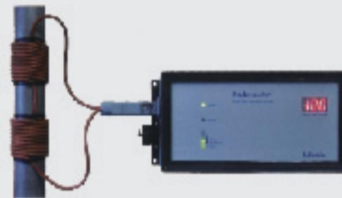
配管外部に巻いたコイルから配管内を流れる水に対し、100~10000Hz に変調された周波の電気信号を伝え、溶存物の結晶の小粒子化を促進します。スケールの結晶化および付着を防止することで配管内部の「つまり」が解消され、配管の延命、熱交換効率アップ等の効能を発揮します。
